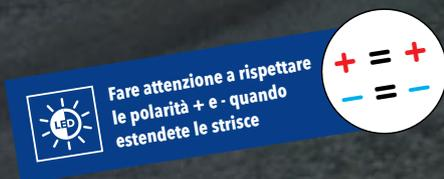
**Nota IMPORTANTE!** Si prega di verificare il perfetto funzionamento del sistema LED, necessariamente prima del completamento finale. Ciò consente di correggere gli eventuali errori di connessione dovuti, ad esempio, ai giunti non perfettamente collegati e quindi ancora in tempo utile per essere correttamente installati. Assicurarsi in oltre che la polarità +/- sia corretta nelle estensioni e/o connessioni.
