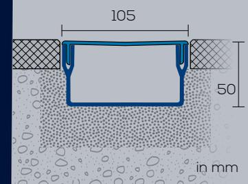
U-DRAIN pro bietet die Möglichkeit eines Seiten- oder Bodenabflusses. Für den Bodenabfluss wird der vertikale Abfluss-Stutzen an einer beliebigen Stelle der Rinne positioniert und der Rinnenboden mittels einer Lochsäge ausgesägt. Der Stutzen wird dann mit dem wasserdichten U-PVC Kleber von DURAL dauerhaft an der Rinne verklebt. U-DRAIN pro Rost und Rinnenkörper können einfach mit einer geeigneten Säge auf die passende Länge gekürzt werden.
